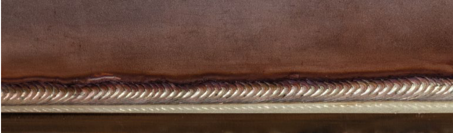
MicorTwin Edelstahl Kehlnaht 6 mm
