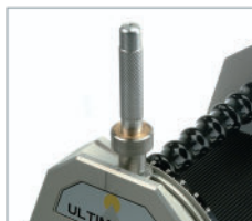
Die Spitze wird um 1/10 mm pro Punkt in der 90°-Position verkürzt.
