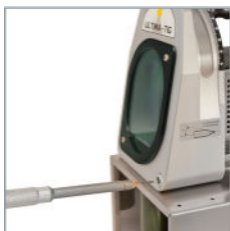
Präzises Justieren der Einstellschablone.
