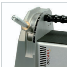
Schleifen der Elektrode im gewünschten Winkel.
