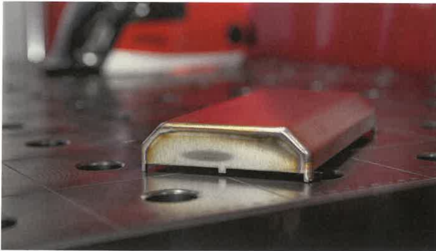
▲ Bild 5. Einmal exakt eingestellt, liefert die „WIG-Edition“ bei Schaefer die für die Tableaus benötigten gleichmäßigen und spritzerfreien WIG-Schweißnähte auch in hoher Stückzahl.
