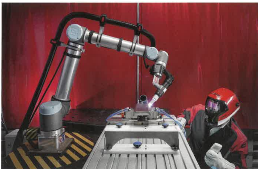
▲ Bild 4. Für die exakte Parametrisierung: Der Zustimmungstaster ermöglicht die Nähe zum Werkstück und einen direkten Blick auf die Schweißnaht.
