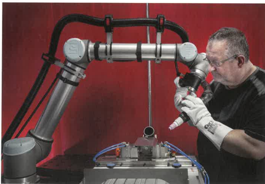
▲ Bild 2. Die Free-Drive-Funktion befindet sich für den Schweißer gut zugänglich direkt an der Brennerhalterung.
